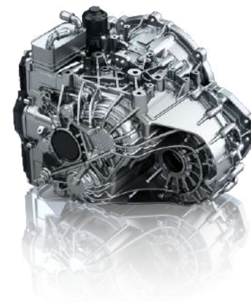
9-ступенчатая роботизированная коробка передач с двойным сцеплением «мокрого» типа
